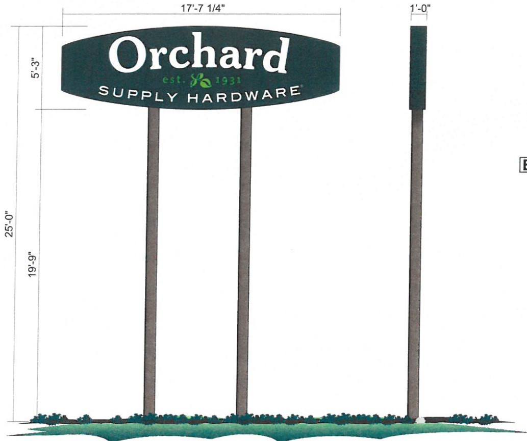
Pylon Elevation - Scale: 1/4" = 1'-0"
