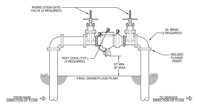
ALL PROPOSED UNDERGROUND FITTINGS MUST BE IN ACCORDANCE WITH THE CITY'S JOINT RESTRAINT REQUIREMENTS (SEE FIGURE 34). ALL BFP'S SHALL BE IN ACCORDANCE WITH APPROVED PLANS BY THE CITY OF WINTER PARK.
