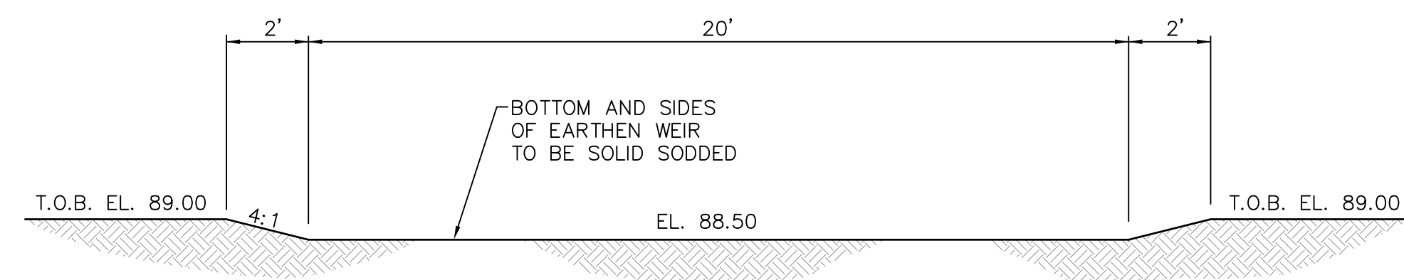
EARTHEN WEIR DETAIL N.T.S.
